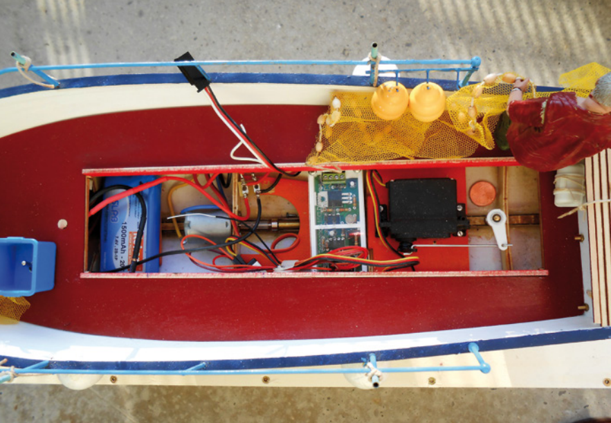
Blick auf die Technik im Rumpf. Links der Hauptschalter in der Fischkiste an Deck
