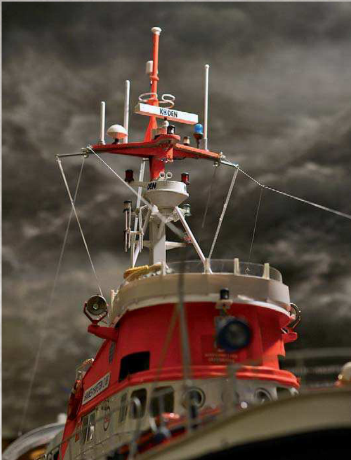
Der beschriebene modernisierte Mast mit Y-Träger und viel technischer Ausrüstung
